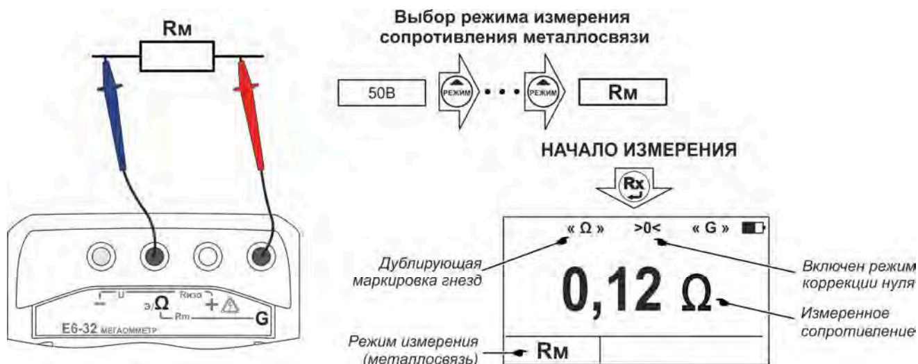
Рисунок 2.8 - Измерение сопротивления металlosвязи
