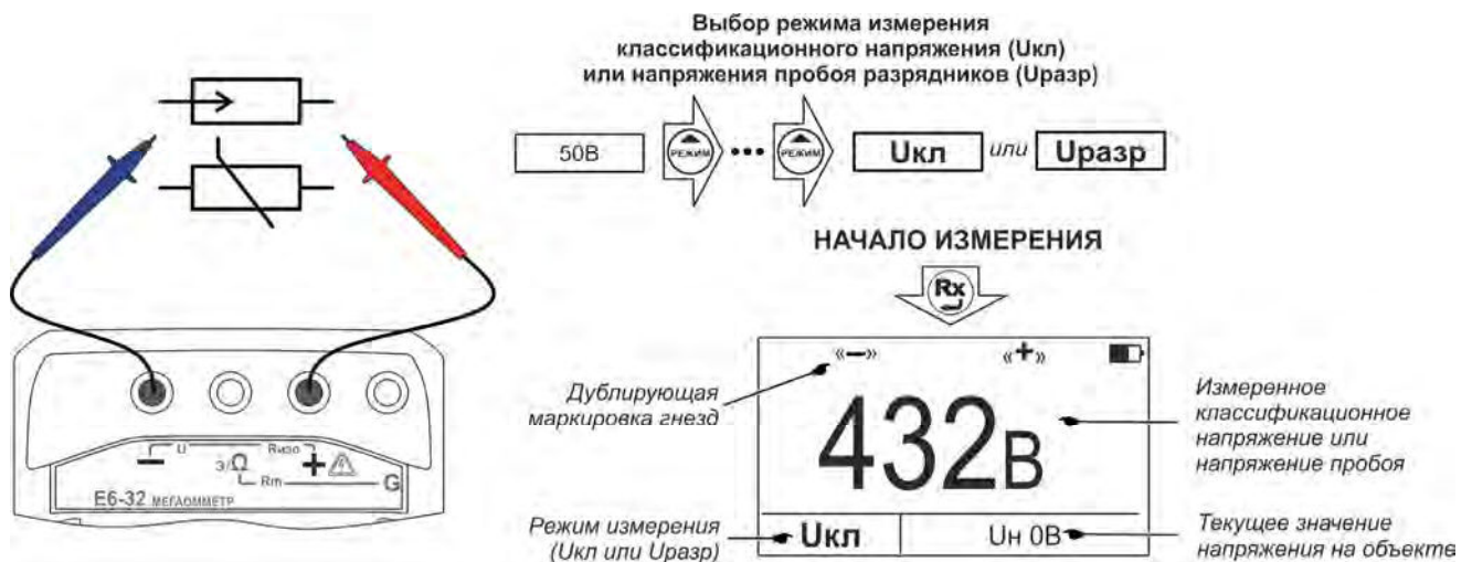
Рисунок 2.10 - Измерение классификационного напряжения или напряжения пробоя разрядников
